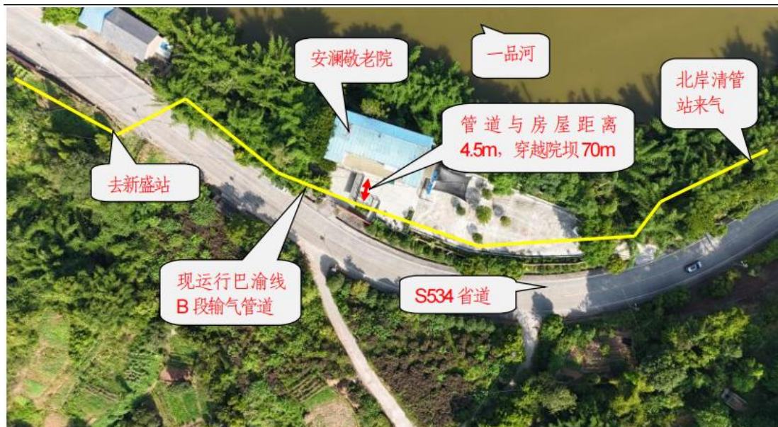
图 2.2-3 隐患位置 B 现有管线隐患情况
